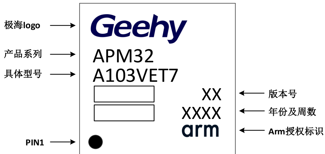
图 16 LQFP100 - 100 引脚, 14 x 14mm 封装标识
